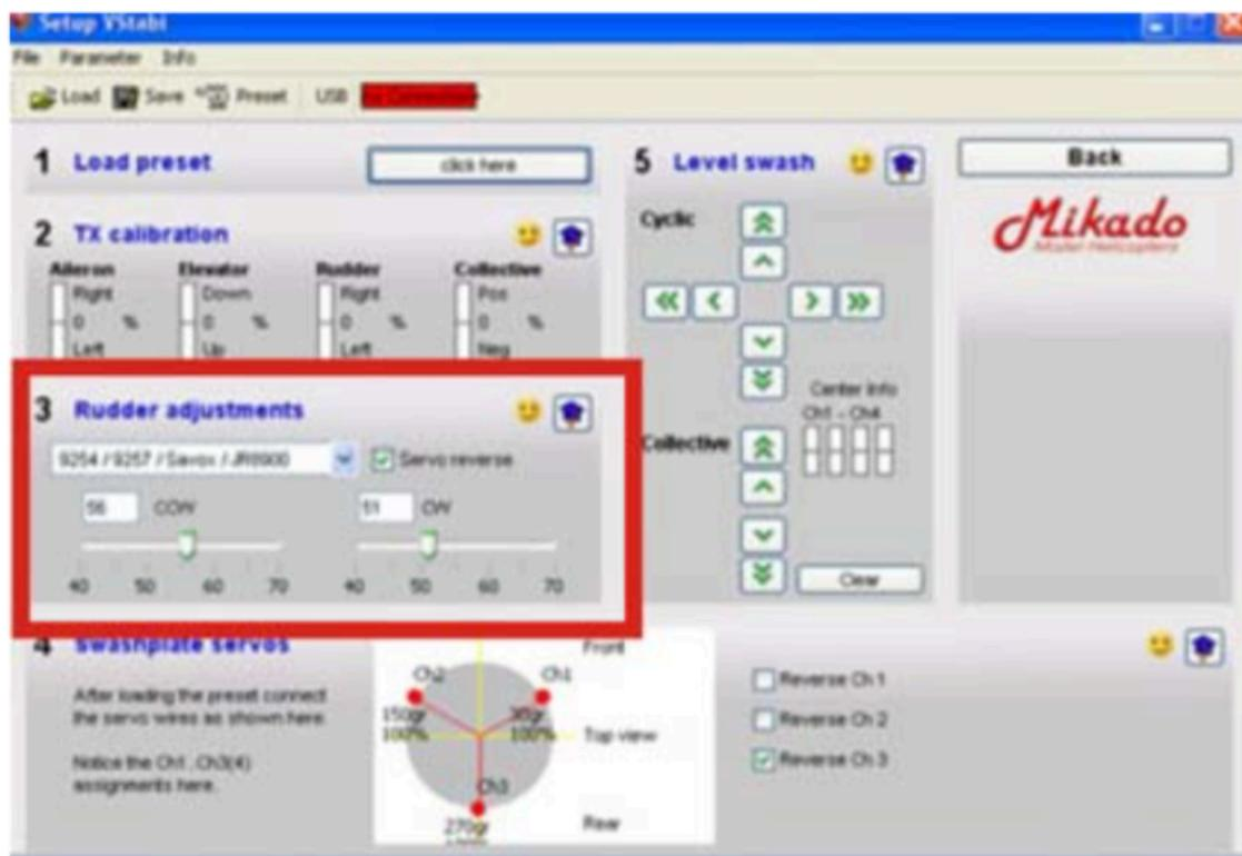
En el paso 3 del procedimiento de configuración se puede llevar a cabo la cola necesaria ajustes para el montaje de la cola. Esto incluye la elección de la correcta Tipo de servo. Si el servo específica no aparece en la lista, póngase en contacto con nuestro equipo de apoyo en el sitio VBar línea ([www.vstabi.de](http://www.vstabi.de)) para obtener el ajuste adecuado.
