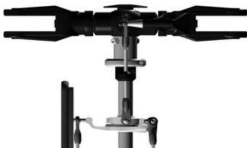
3) Es Necesario Instalar ONU Controlador de plato cíclico. Mikado OFRECE Una . Controlador Del Plato oscilante párr 10 mm Principales ejes de rotor CUENTA CON RODAMIENTOS Ocho de bolas:
