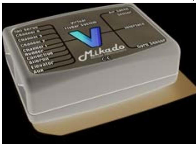
El criterio esencial para el posicionamiento de la unidad central tiene que ver con alambrado. El receptor debe estar conectada sin tirar o doblar el alambres. Al mismo tiempo, la unidad central debe conectarse a la servos del plato cíclico. El servo de cola también debe estar conectado.
